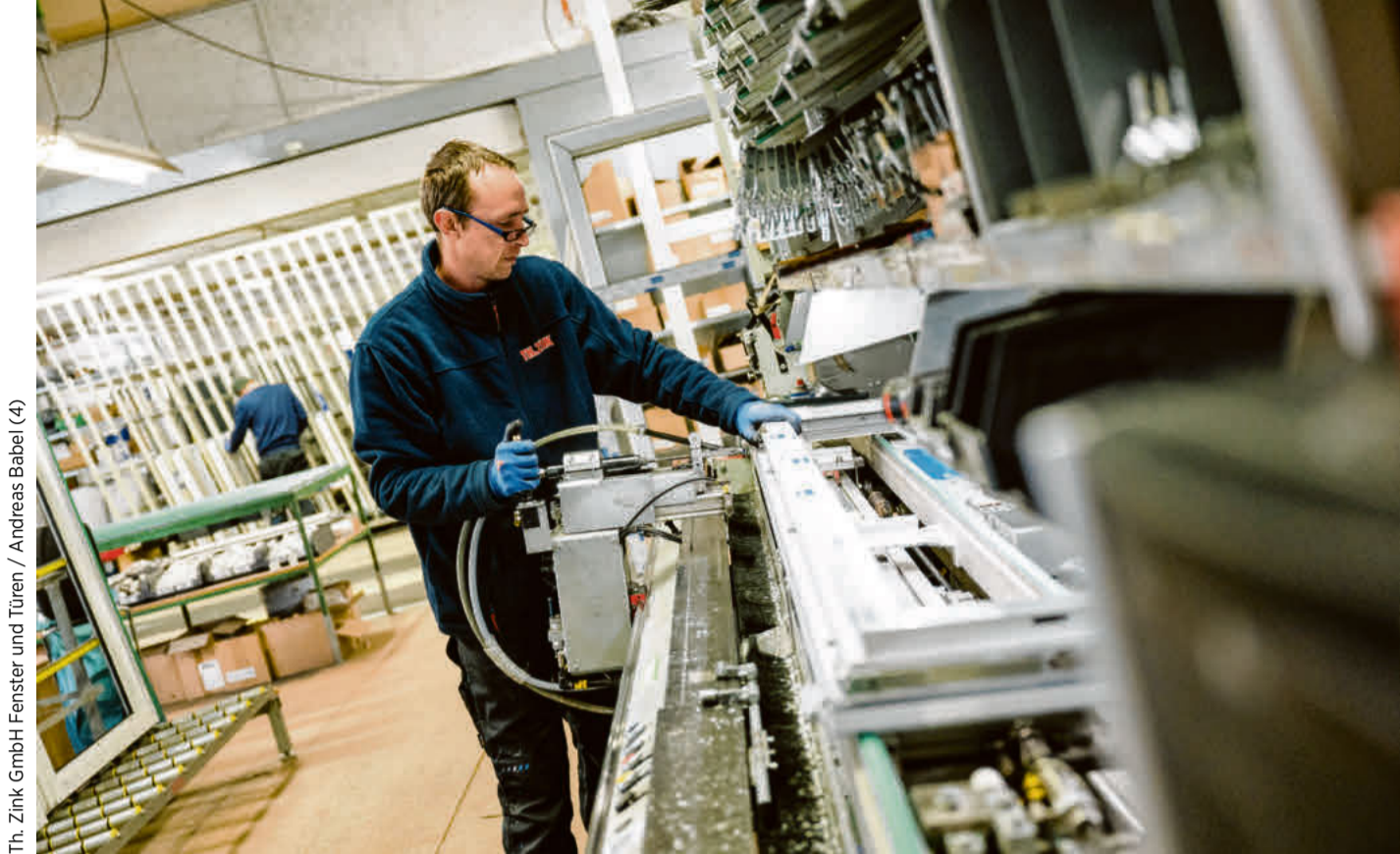
Marco Bangnowski arbeitet am Flügelanschlag. Hier wird der Flügelbeschlag in das jeweilige Flügelprofil geschraubt. Die Beschlag-Bauteile beinhalten dann den Schließzapfen. Dieser verriegelt den Flügel mit dem Rahmen.
